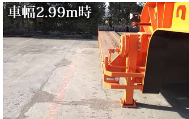
車幅3.19mへ拡幅中
