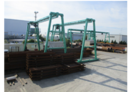
5.0t吊門型クレーン導入
